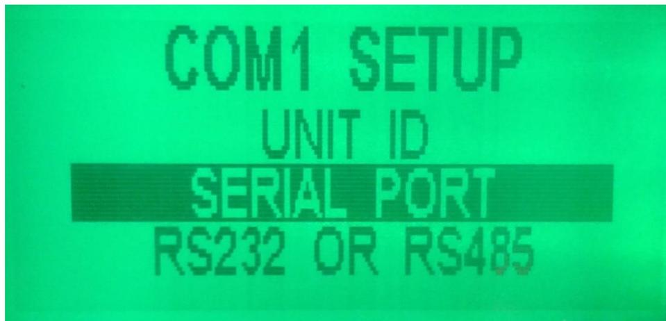
Figura 4.3.10 Luego en la configuración del puerto serial seleccionar tipo de paridad
