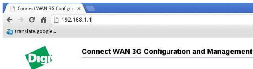
**Figura 3.3.1 Dirección IP local por defecto, para ingresar el Web-UI**
