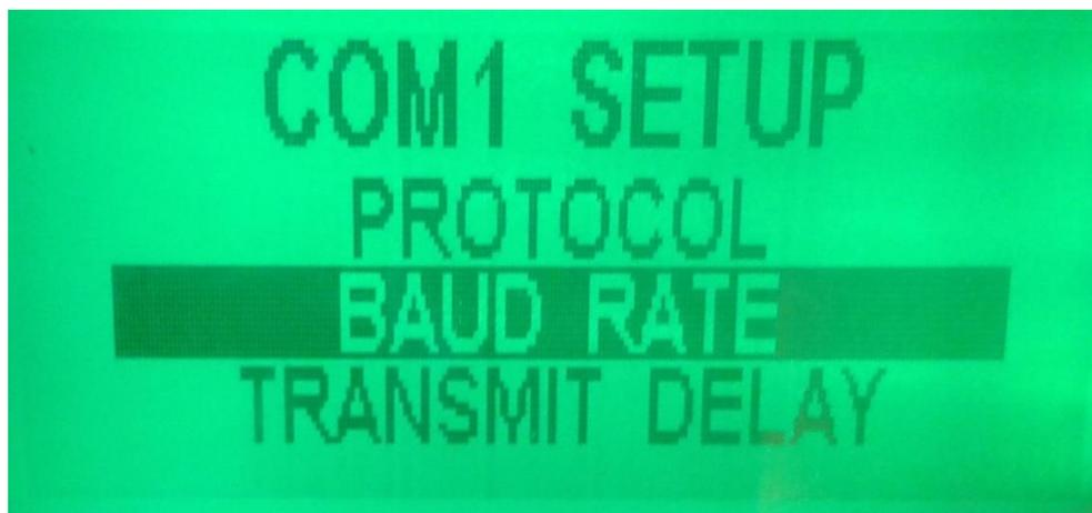
Figura 4.3.4 Luego ir a "Baud Rate" para configurar la velocidad del puerto serial
