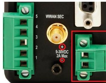
Figura 3.2.1 Conector de fuente de poder con tornillos de sujeción
