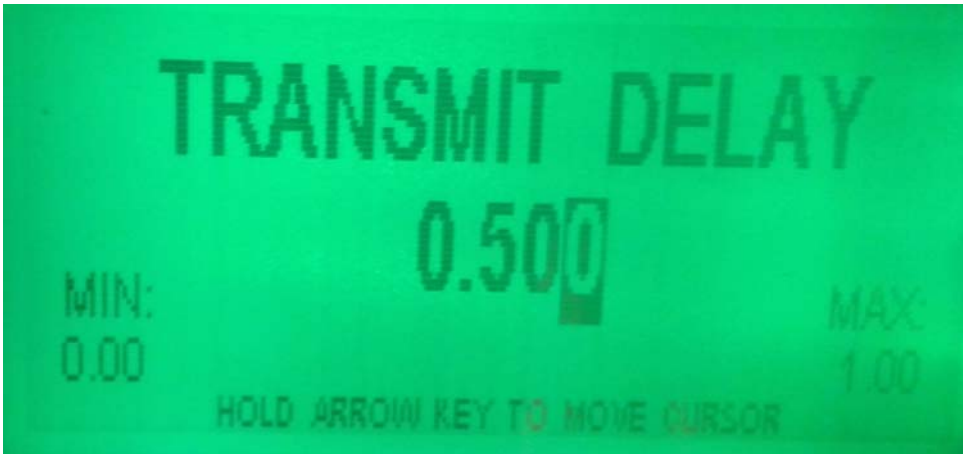
Figura 4.3.7 Agregar retardo de 500ms Fuente: Elaboración Wamtech (año 2013)
