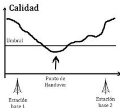
Figura 2.3.3 Traspaso de señal en la zona de Handover
