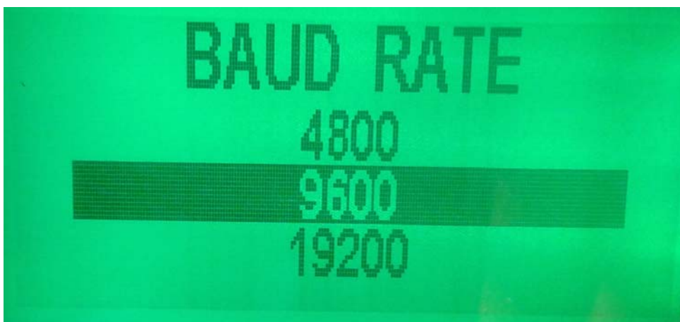
Figura 4.3.5 Seleccionar 9600 Baudios (Velocidad recomendada para tramo celular) Fuente: Elaboración Wamtech (año 2013)
