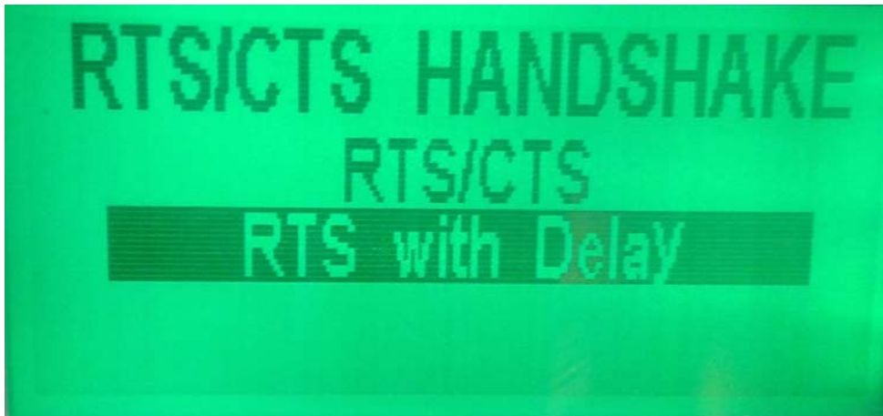
Figura 4.3.15 Seleccionar realimentación con retardo
