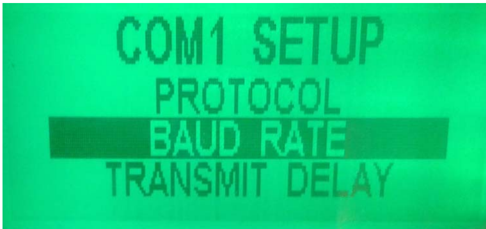
Figura 4.3.4 Luego ir a "Baud Rate" para configurar la velocidad del puerto serial Fuente: Elaboración Wamtech (año 2013)
