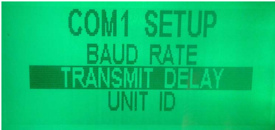
Figura 4.3.6 Seleccionar opción de retardo Fuente: Elaboración Wamtech (año 2013)
