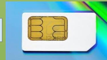
**Asegúrese de que en la Sim Card esté desbloqueado el código Pin, de estar con bloqueo Pin, es posible incorporar el código en la programación, para que el aparato Digi desbloquee la Simcard.**
